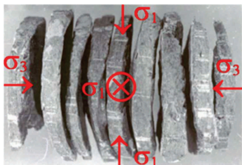
Figura 18c – Disco curvos em forma de prato e as tensões atuantes.
